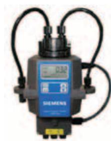
Mutnoća vode je uzrokovana suspendiranim tvarima kao što je mulj, pijesak i mikroorganizmi. Mutnoća se može mjeriti pomoću optoelektronskog mjeraca. Umjetni izvor svijetlosti emitira poznati intenzitet svjetla kroz uzorak. Suspendirane tvari raspršuju ili apsorbiraju svjetlost. Raspršena svjetlost se zatim mjeri fotodetektorom, najčešće pod kutem od 90° i rezultati se izražavaju u NTU.
